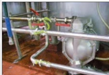
Pompe de transfert sanitaire 3" (76,20 mm) utilisée pour transférer la substance de base nécessaire à la fabrication de shampoings
