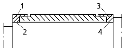
III. 7: Montage de la chemise d'arbre sous coussinet sur l'arbre
