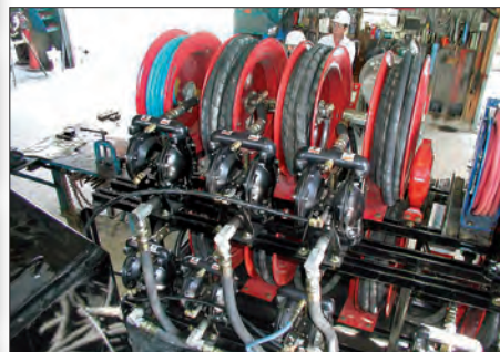
Pompes de transfert à combustible 1" (25,40 mm) certifiées U.L., assemblées sur les châssis permettant de faire le plein/de retirer l'excédent de kérosène des avions
