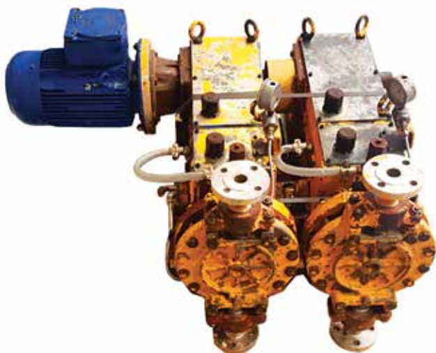
Ensemble de dosage avant remise en état
