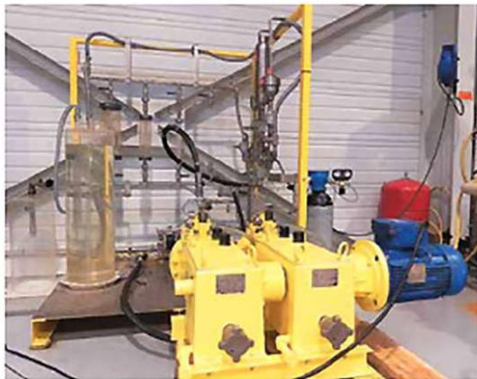
Banc d'essai pour pompe doseuse au centre de maintenance de Moirans.
