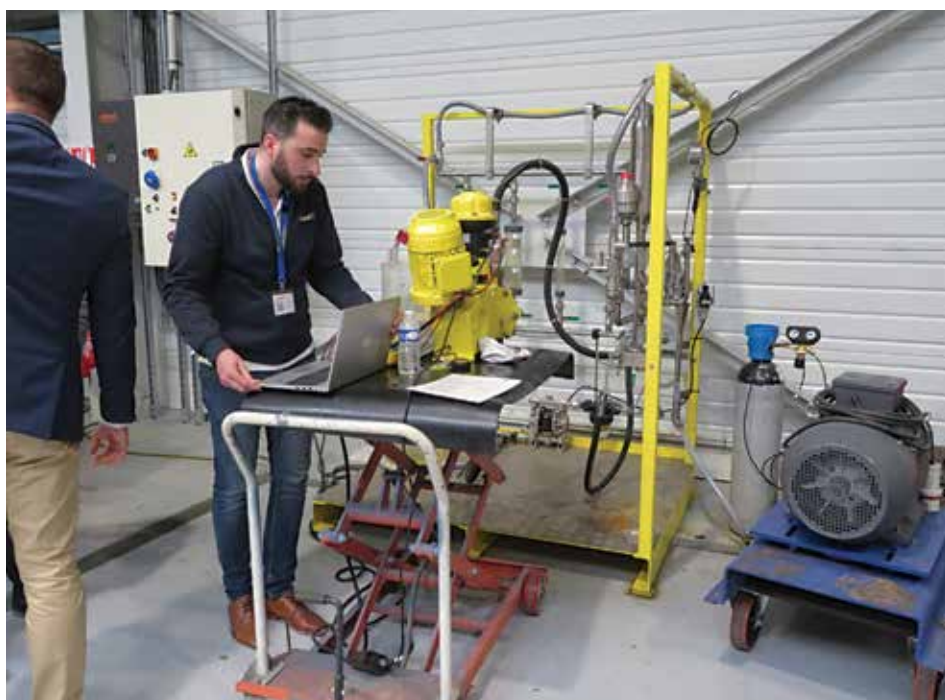
Le banc de test des pompes doseuses
